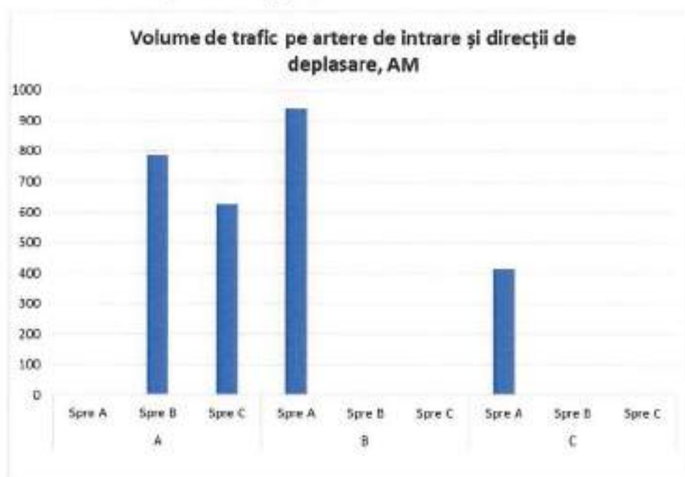
Fig. 3.2. Repartiția volumelor de trafic pe direcții de deplasare: Bulevardul Aurel Vlaicu – Pasaj Aurel Vlaicu – AM (model)
