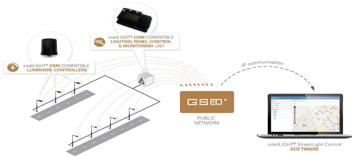
Fig: arhitectura sistemului de telegestiune pe platforma GSM
